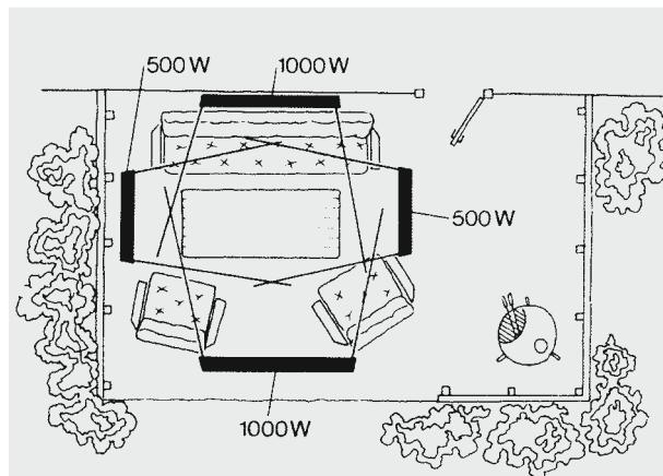
Рис. 1: Типичный пример расположения приборов. Комфорт обеспечивается при тепловом потоке равном примерно 1000 Вт/м<sup>2</sup>.
